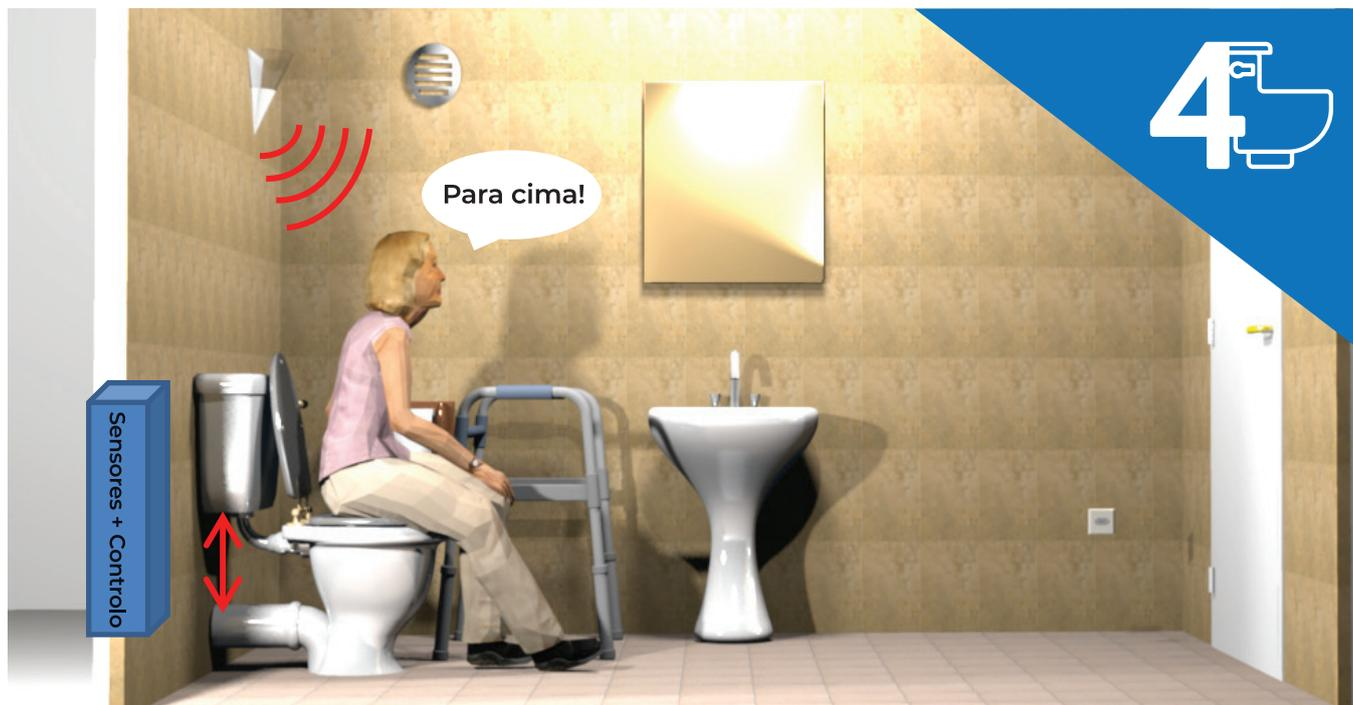
Conceito Toilet4me: Instalação sanitária automaticamente ajustável com uso de TIC
